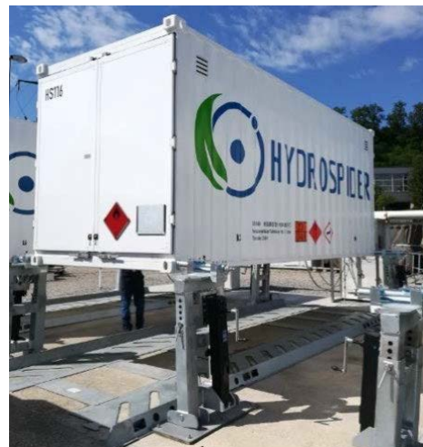
Abbildung 33: Anlieferung Vernconex-Container durch Hydros spider (links) und H 2 -Container auf Docking-Station (rechts)
